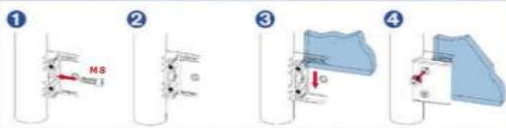
Fig.3 Fasi di montaggio dei Serravetro tramite mascheratura M8 del tubo dopo averlo forato con punta Diam. 8,8. Si consiglia l'utilizzo dell'inserto M8 che si applica al tubo con appositi utensili dopo averlo forato con punta corrispondente. La nostra preparazione del tubo prevede la foratura per fusione e la successiva rullatura M8.
